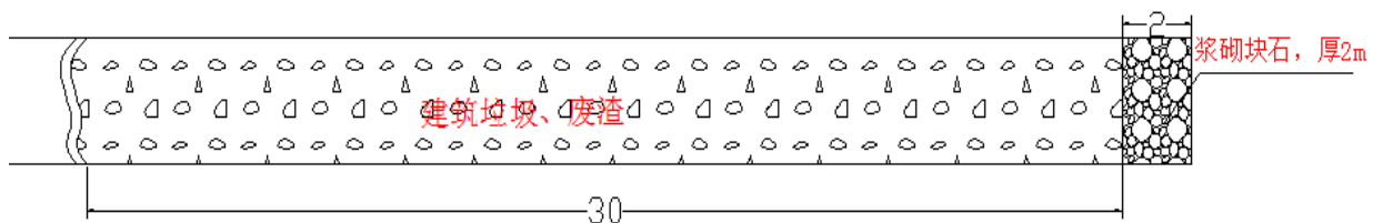
图 10-3 硐口封堵设计断面示意图（单位 m）
