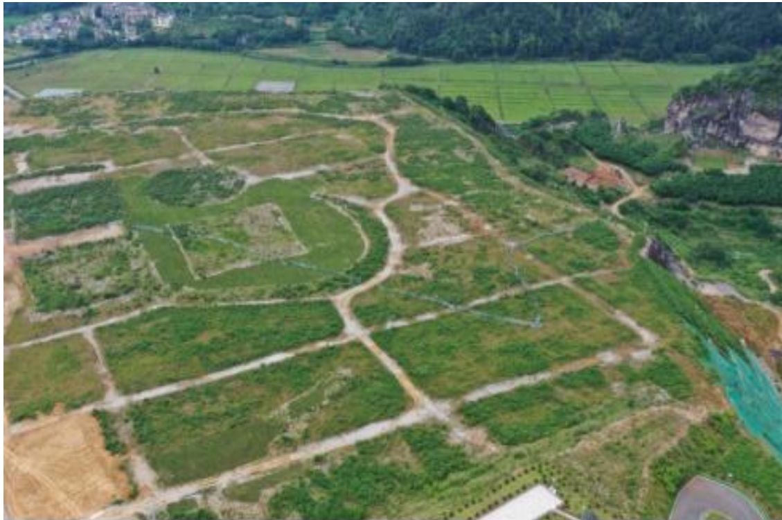
图 2-7 矿区东侧已分割平台绿化
